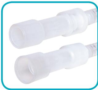
Adapter mit 15/22 mm männlichem/weiblichem Verbindungsstück und integriertem Probenfilter
